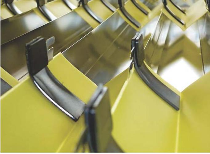
Durch den modularen Aufbau kann die Abdeckung bei Änderungen der Längenanforderung oder bei Reparatur eines Elementes materialschonend verlängert, verkürzt oder teilweise ausgetauscht werden
